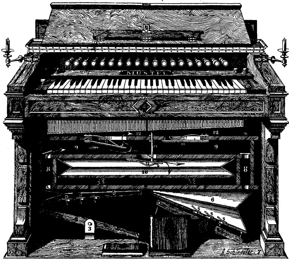
*L'intérieur de l'instrument, ci dessus représenté en coupe n'est pas rigoureusement conforme à la réalité. C'est une exposition conventionnelle extrêmement simplifiée du rôle de la soufflerie et de sa fonction dans l'harmonium.*
