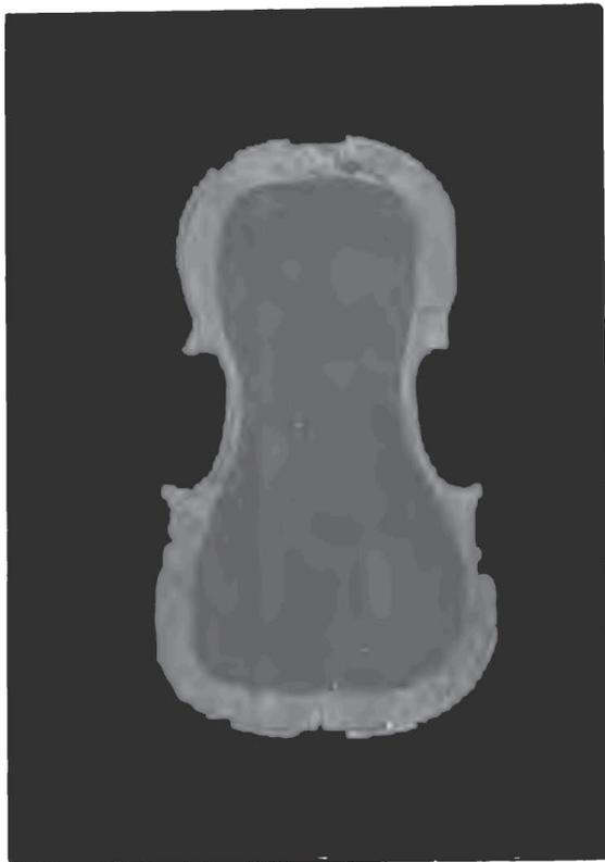
Fig. 83. — TABLE PRÉPARÉE POUR RECEVOIR DES DEMI-BORDS.
